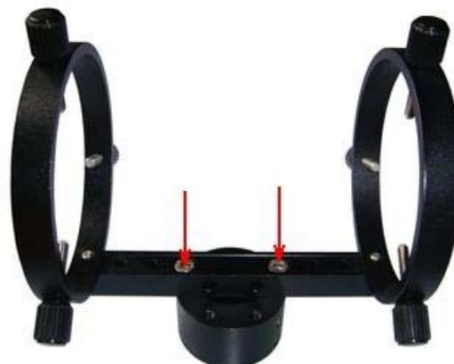
5.- Monte el soporte de telescopio lateralmente sobre la base cilíndrica (**Two-T** y **Mix**): use los tornillos M6 x 25mm para fijar el/los soporte/s de lado sobre la base cilíndrica.
