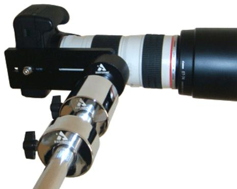
8.- Equilibre la montura en el eje de declinación desplazando el telescopio principal hasta alcanzar la posición de equilibrio.
