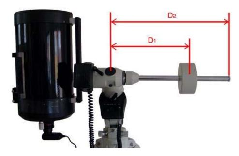
Mida la distancia a la que está la mitad de la pesa o conjunto de pesas respecto al eje de giro en A.R.  $(D_1)$ , vuelva a situar la montura en posición vertical bloqueando el eje de Ascensión Recta. Si desconoce cuanto pesan las contrapesas (P), extráigalas de la barra y use la báscula. Pese el telescopio guía o la cámara que tiene pensado usar sobre el DuoScope (PA). Mida la longitud total de la barra  $(D_2)$ .
